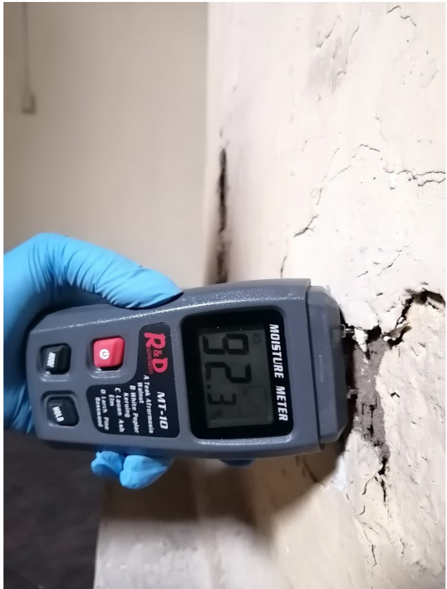
Figura 4. Instrumento para medir la humedad del soporte.
